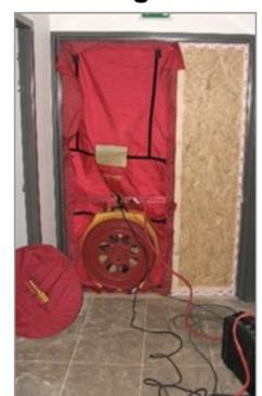
Test d'étanchéité à l'air avec porte soufflante (« Blower Door »)
